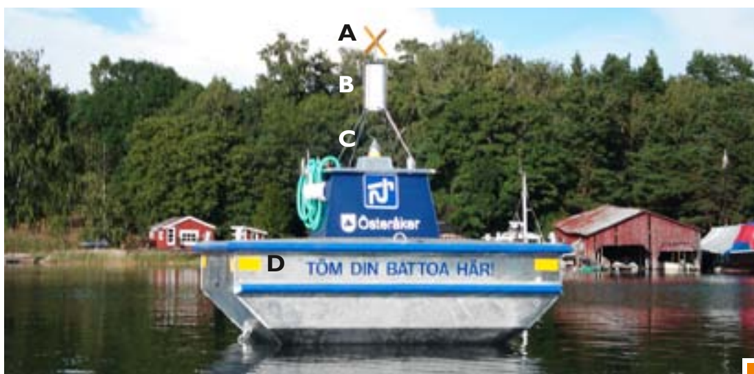
A: Gult kryss i fluorescerande (självlysande) färg. B: Radarreflektor. C: Gult blyxtljus med karaktären FI Y 3s 3 M. D: Gula reflexer.
